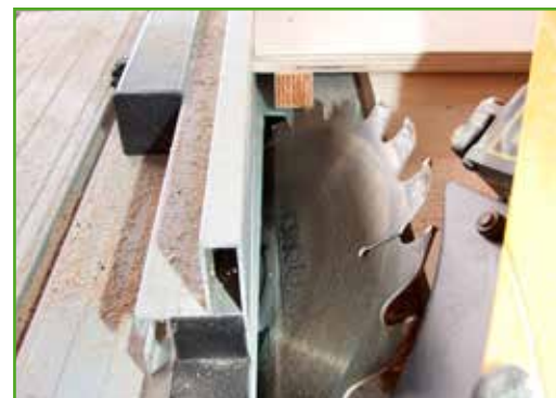
Abb. 2: Die Schnittführung mit der Tischkreissäge.
