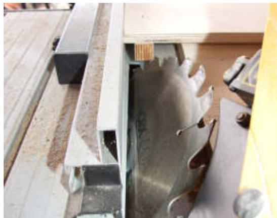
**Abb. 2:** Die Schnittführung mit der Tischkreissäge.
